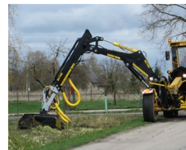
SC160 • En robust kran med lång räckvidd upp till 11 meter och dubbelteleskopsteknik. För röjning av de större vägnäten.
