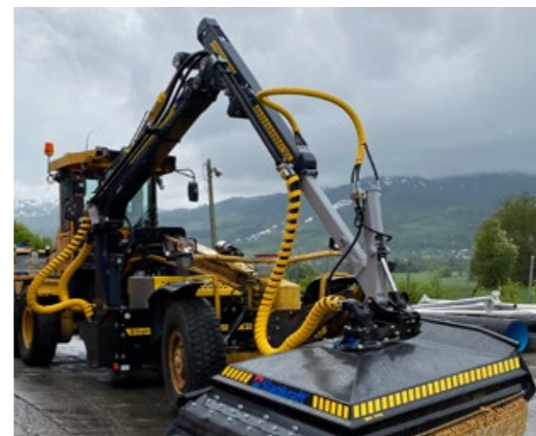
SC8 • En kran med den senaste tekniken, hög kranpelare och skyddad konstruktion. Räckvidd upp till 8,5 meter.
