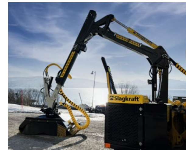
SC7 • En modern kran med hög kranpelare, kortare lyftarm och skyddad slangdragning. För röjning av mindre vägar.
